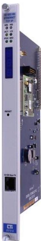
La 2572-B si inserisce nel percorso della 2572 e della 2572-A, con l'aggiunta di un display frontale per l'indirizzo IP e con l'eliminazione della porta di configurazione seriale.
